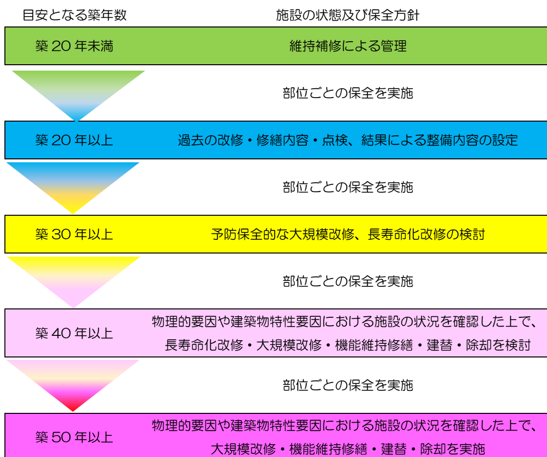
図 施設全体の基本となる改修周期と工事規模のイメージ
